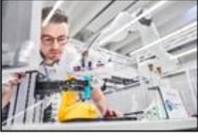
프라운호퍼 기전공학 시스템 설계 연구소(Fraunhofer IEM)에서 개발한 새로운 로봇 그리퍼는 압력을 감지할 뿐만 아니라 역동적이고 에너지 효율적이며 다양한 용도로 쓰일 수 있다는 점에서 특별하다. 이는 부서지기 쉬운 물체를 한 생산 공정에서 다음 생산 공정으로 손상 없이 옮길 수 있다. 이 그리퍼는 쉽게 부서지는 제품을 조심스럽게 다룸으로써 특히나 식품 업계에서 폐기물을 줄일 수 있도록 설계되었으며, 전기를 동력으로 하기 때문에 값비싼 기체역학을 필요로 하지 않는다. 로봇 그리퍼는 오는 4/17~21 일까지 2023 하노버 산업박람회의 프라운호퍼 공동 부스(Hall 16, Booth A12)에서 전시될 예정이다.
