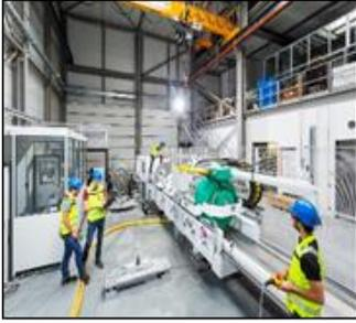
지열저류층 개발을 위한 지각의 심부시추는 고온 고압의 환경에서 이루어지기 때문에 고비용이고 시간 소모적이라는 단점이 있다. 프라운호퍼 에너지 인프라 및 지열시스템 연구소(IEG)는 지표면에서 수천 미터 아래의 시추 환경을 가상으로 시뮬레이션하여 지열발전의 효율성을 개선하는 시험 장치를 개발했다.
